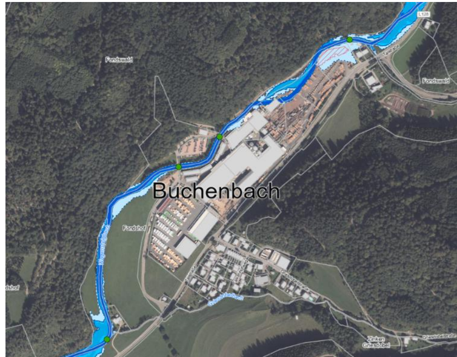
Abb. 5: Überflutungsflächen gemäß Hochwasserrisikomanagement-Abfrage
